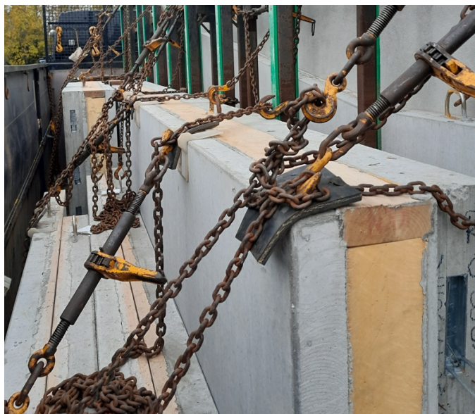
Kuva 3. Sekä sidontaketjut että kuorma suojataan vaurioitumiselta.
