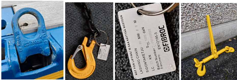
Kuva 2. Sidontapisteiden ja sidontavälineiden suoritusarvot merkittyinä välineisiin. Välineiden on oltava kunnossa. Eri sidontavälinevalmistajat ovat määritelleet ketjuille ja kiristimelle niiden suoritusarvot, jotka ovat merkittyinä välineisiin. Valmistajan ilmoittamia suoritusarvoja sekä käyttöohjeita on noudatettava kuormansidonnassa.
