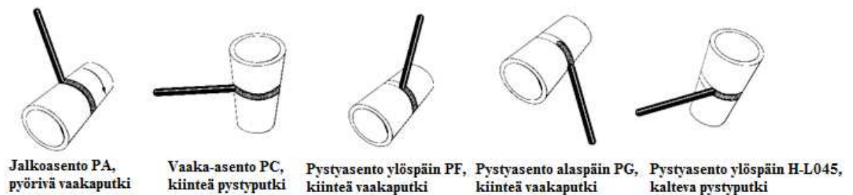
Kuva 5. Päittäishitsiasennot putken hitsauksessa [3].
