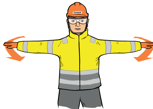
Опасность, аварийная остановка
