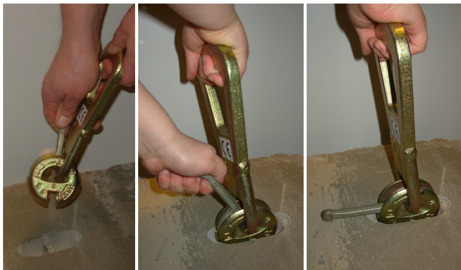
Kuva 24. Lukkosalvalla lukittava nostoapuväline RR-reikärautalukko. (Kuvat: Peikko Finland Oy)
