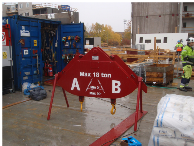
Kuva 38. Kuormia tasaava laite, jos nostoelimet eivät sijaitse symmetrisesti painopisteen suhteen. (Kuva: Voller Oy)
