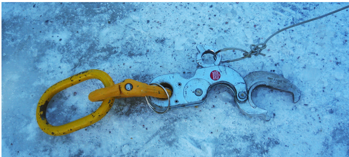
Kuva 25. Esimerkiksi korkeiden seinäelementtien nostamisessa on turvallista käyttää apuna nostokoukkuja, jotka voidaan avata maasta laukaisinnarun avulla. Samalla vältetään tikkaiden käytöltä.
