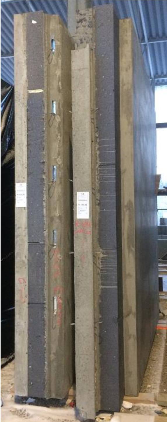
Kuva 5.5.1 Elementti "kovalla" eristeellä, ei suojausta
