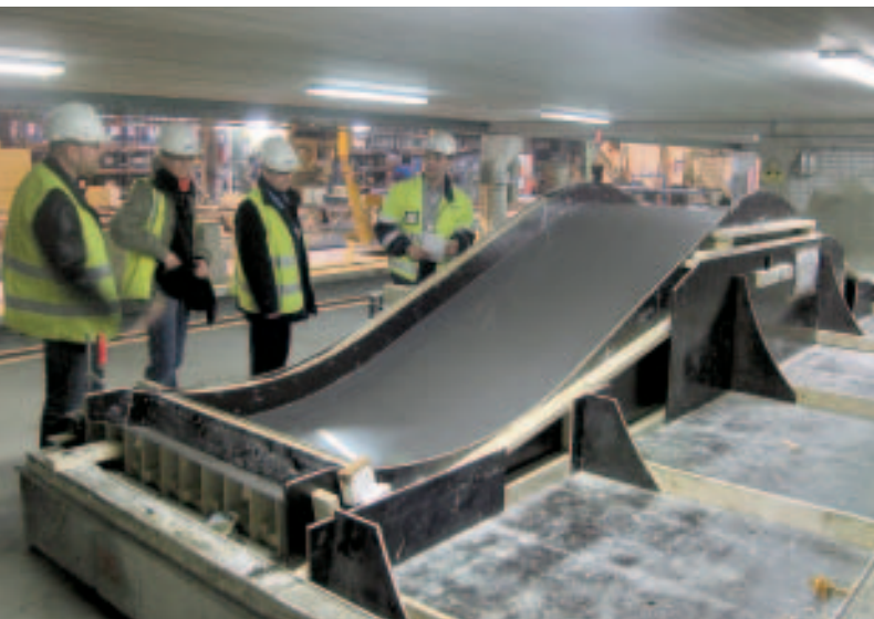
18 Vanerimuotit vaihtuivat teräksisiksi.
