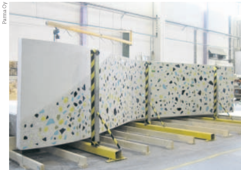
19 Elementintekijän kannalta vaativinta olivat parveke-elementtien hienosti kaartuvat muodot.
