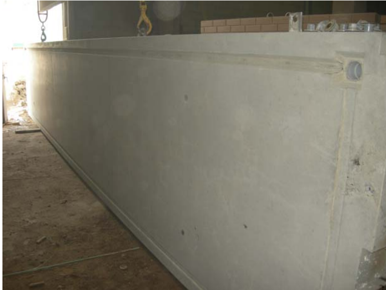
Kuva 6. Pitkä esijännitetty parvekelaatta tehtaalla.
