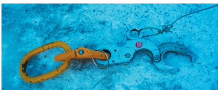
Kuva 6. Seinäelementtien nostamisessa on turvallista käyttää apuna nostokoukkuja, jotka voidaan avata maasta laukaisinnarun avulla. Näin vältetään tikkaiden käytöltä.
