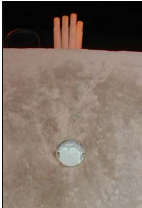
Kuvat 7 ja 8. Vasemmalla perinteinen väliseinäelementti. Oikealla sähkörasia on kiinnitetty valumuottiin magneetilla. Ratkaisu on valmistusteknisesti hyvä ja lopputulos on laadukas /kuva 8. Harri Bergholm/.
