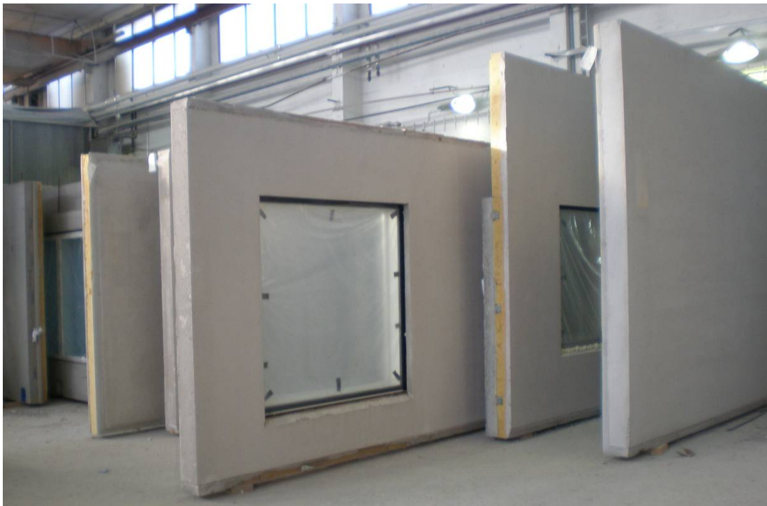
Kuva 7. Parma oy:n Forssan tehtaalla ikkunoita on asennettu tehtaalla elementteihin.
