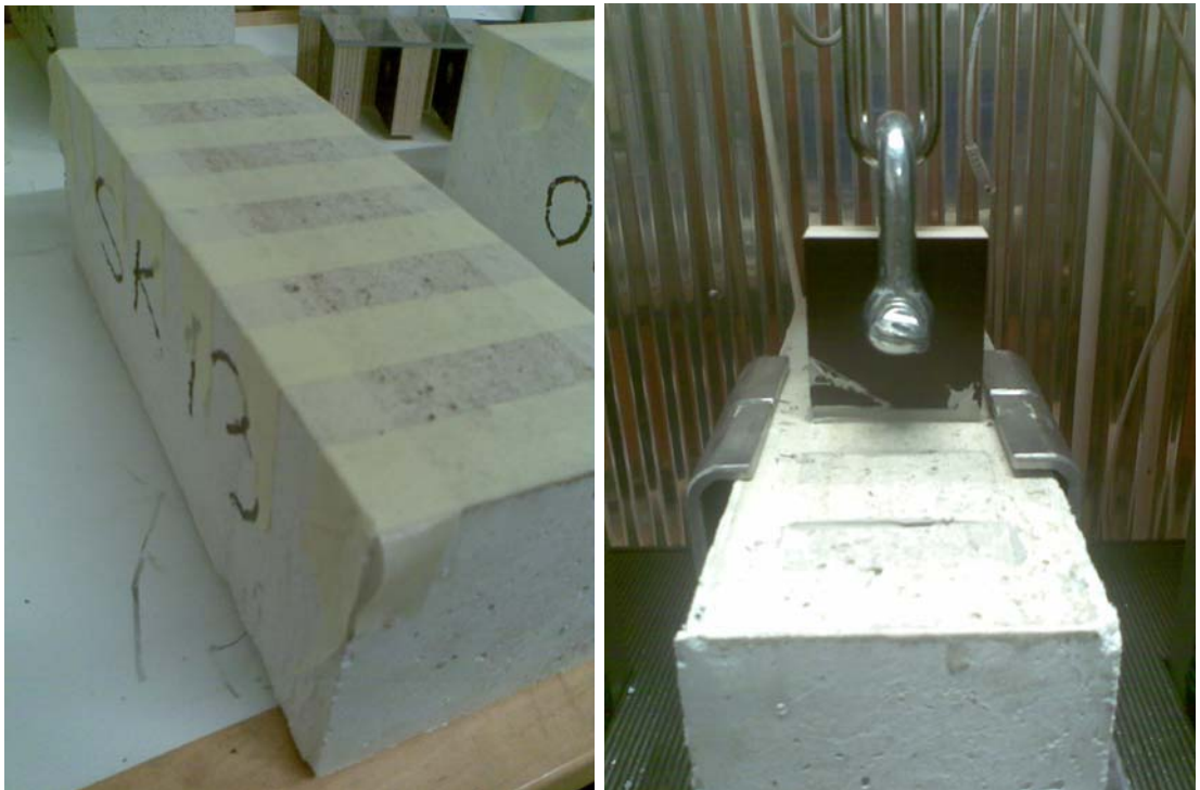
Kuva 3 Tartunta-alueiden rajaus teippaamalla ennen vetokappaleiden kiinnittämistä ja vetokokeen koejärjestely..
